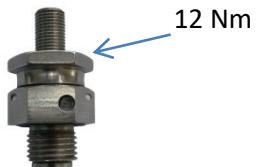
Forladningsudstyret bruges til at aftappe eller påfylde kvælstof.
